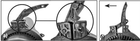
Снять хомут с муфты (стыка оголовника и кожура).
