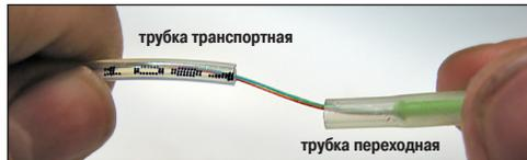
**2.4.2.4** Промаркировать самоклеющимся маркером транспортную трубку, надвинутую на ОМ, в соответствии с нумерацией этого ОМ.
