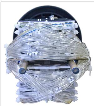
**2.8** Скрепить с каждой стороны смонтированных блоков кассет пучки трубок транспортных с кронштейном муфты стяжками нейлоновыми.
