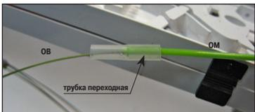
**2.4.2.3** Ввести пучок ОВ в отрезок транспортной трубки; осторожно продвинуть отрезок этой трубки к месту установки на ОМ переходной трубки и вставить в переходную трубку, до упора в торец ОМ.
