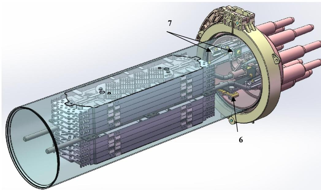
Количество размещаемых в муфте сростков ОВ, защищенных КДЗС, определяется количеством устанавливаемых в муфте кассет (максимально - 10 шт. кассет К48-4525):
