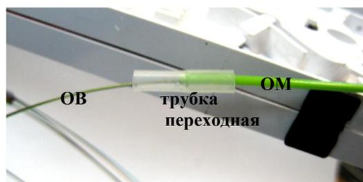
**14.2.3.3** Ввести пучок ОВ в отрезок транспортной трубки; осторожно продвинуть отрезок этой трубки к месту установки на ОМ переходной трубки и вставить в переходную трубку, до упора в торец ОМ.
