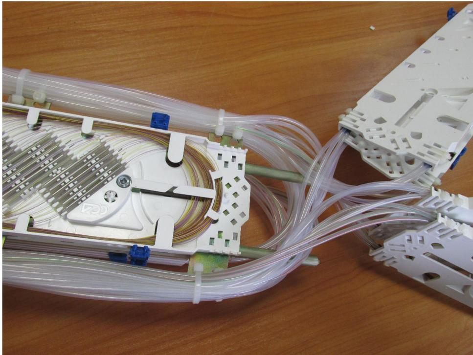
**15.7** При соблюдении **рекомендуемых** радиусов изгиба ОВ в трубках оптических модулей и **условия их эластичности и стойкости к излому при изгибе**, возможно осуществлять ввод ОМ на кассеты № 2÷5; 7÷10 без применения транспортных трубок, со сторон этих кассет, **противоположных оголовнику**. При этом разделку ОК выполнять в соответствии с схемой 6.
