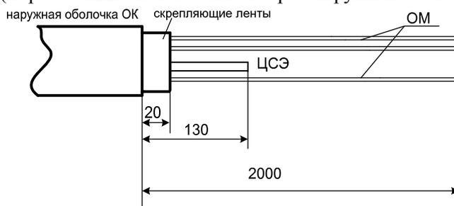
Схема разделки при вводе ОК:
