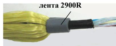
**8.3.2** Уложить пучки арамидных нитей вдоль кабеля в сторону разделанного конца, равномерно распределив их по окружности. Наложить на наружную оболочку и нити ленты 2900R шириной 20 мм в один слой, размещая ленту симметрично относительно среза наружной оболочки.
