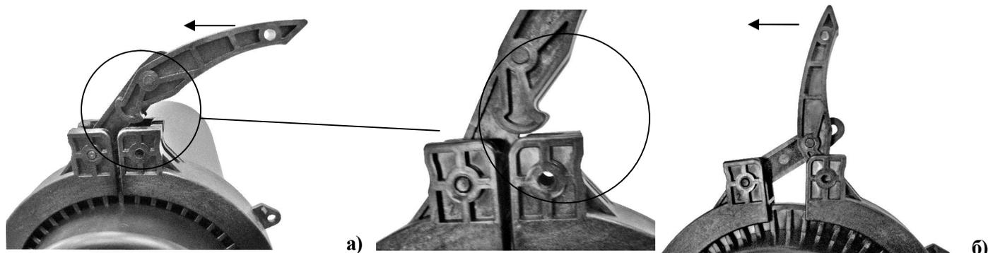
3 Снять хомут с муфты (стыка оголовника и кожуха). Снять кожух с оголовника.
