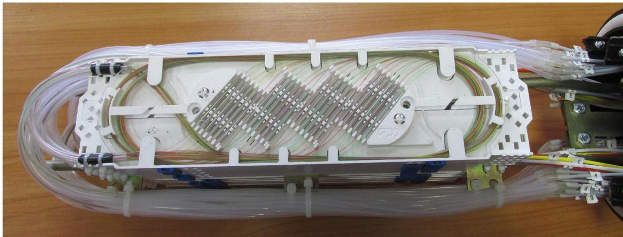
**14.4** На рисунке показан вид на смонтированную муфту со стороны торцов блоков кассет.
