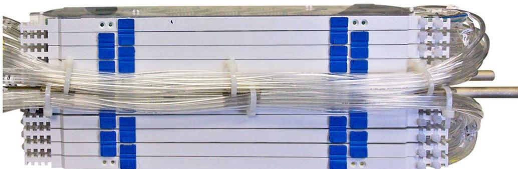
**14.6** Доступ к ОВ на кассетах № 1...4 и № 7...10 нижнего уровня обеспечивается за счет смещения расположенных выше кассет в сторону от оголовника.
